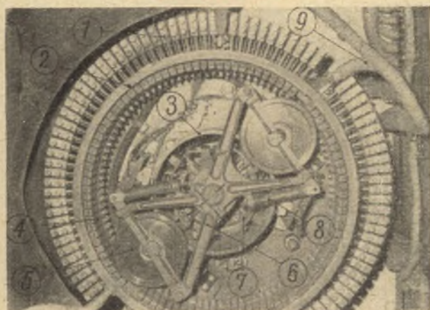
Rys. 9. Wagon „13N” — rozrusznik: 1 — wieniec z oporników rozruchowych „Br”, 2 — listwa zbiorcza kontaktowa (miedziana), 3 — urządzenia dodatkowe, 4 — palce stykowe, 5 — krążki dociskające palce stykowe do listwy zbiorczej, 6 — krzyżak krążków dociskających napędzany przez silnik „PM”, 7 — urządzenia pomocnicze przygotowujące układ hamowania przy jeździe z rozpędu, 8 — sprężyny dociskowe krążków, 9 — przewodniki elektryczne obwodu trakcyjnego
