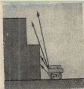
Rys. 6. Schemat ochrony przeciwdźwiękowej w postaci cofnięcia górnych kondygnacji budynku
